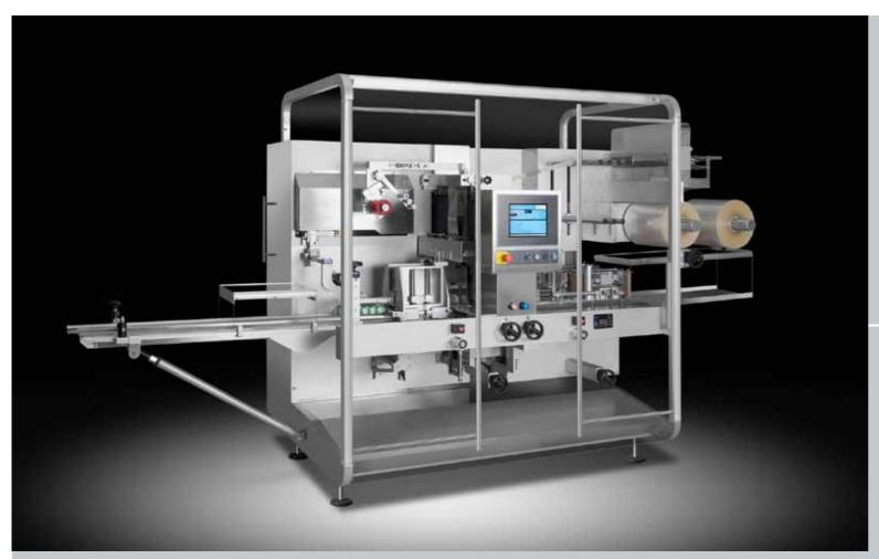
1 FULLY AUTOMATIC FILM SPLICER AUTOMATIC FILM CHANGE-OVER WHILE THE MACHINE IS RUNNING
