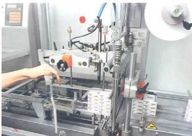
Interno tramoggia accessibile e ispezionabile, aprendo la sponda laterale. Scale millimetriche e visualizzatori di quote per facilitare le regolazioni.
