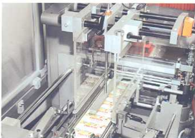
Particolare del gruppo di introduzione desmodromica del fardello nella stazione di avvolgimento. Alla fine dell'introduzione gli spingitori ritornano in posizione all'esterno delle sponde tramoggia, lasciando sempre libera la zona di impilamento.
