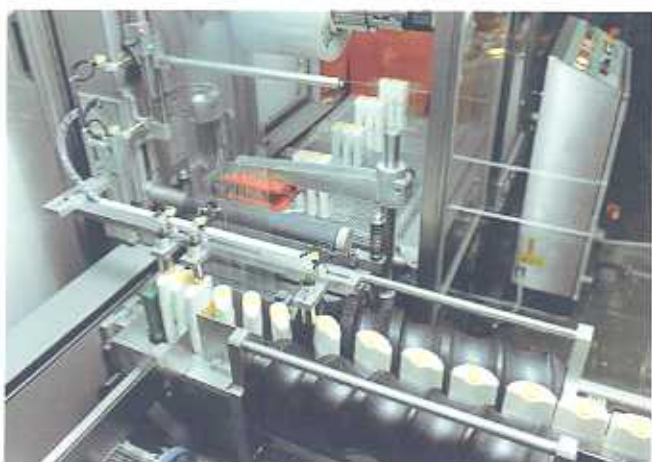
Alimentazione a 90° per flaconi, orientati durante il trasporto con un dispositivo a coclea.
