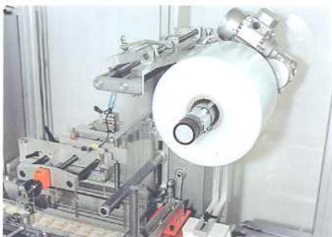
Mandrino con bloccaggio a espansione per il cambio rapido delle bobine.
